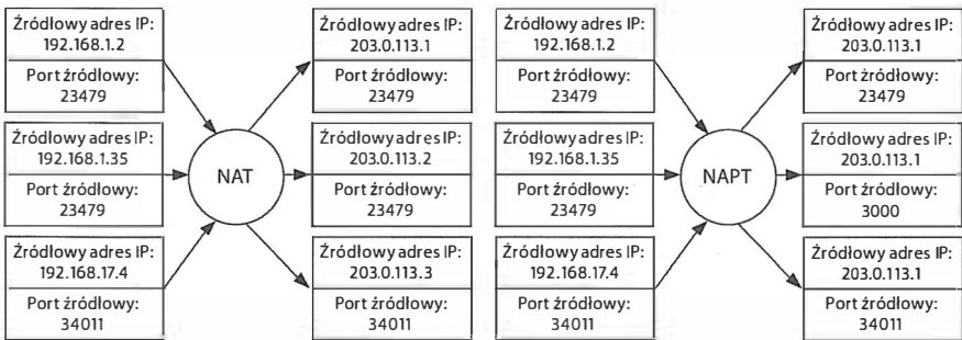
Rysunek 7.4. NAT w wariancie podstawowym (lewa strona rysunku) oznacza mapowanie lokalnych adresów IP na adresy globalne z dostępnej puli, bez zmiany numerów portów. W wariancie NAPT, znanym także pod nazwą maskarady, konwersji podlegają nie same adresy, lecz pary „adres:port”. W sytuacji przedstawionej po prawej stronie rysunku, gdzie dostępny jest tylko jeden globalny adres, w wersji podstawowej NAT pierwsze i drugie połączenie zostałyby odwzorowane na parę 230.0.113.1:23479, co spowodowałoby utratę jednoznaczności mapowania
