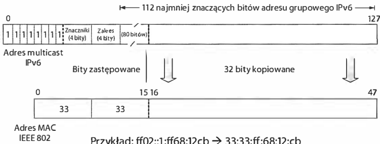
Rysunek 9.3. Mapowanie adresu IPv6 na adres MAC IEEE-802. Do prefiksu 33:33 dołączone zostają 32 najmniej znaczące bity adresu IP. Ponieważ można w ten sposób utworzyć 2^{32} różnych adresów MAC, a liczba możliwych adresów IPv6 multicast wynosi 2^{112} , więc odzworowanie nie jest jednoznaczne — na dany adres MAC mapowane jest 2^{80} różnych adresów IPv6
