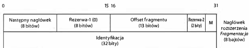
Rysunek 5.11. Nagłówek rozszerzenia Fragmentacja . Pole identyfikacyjne jest dwukrotnie większe niż w nagłówku IPv4, offset fragmentu oznacza przesunięcie fragmentu, liczone w jednostkach 8-bajtowych, względem początku części fragmentowalnej oryginalnego pakietu. Bit M jest wyzerowany w ostatnim fragmencie pakietu i ustawiony na 1 w pozostałych fragmentach
