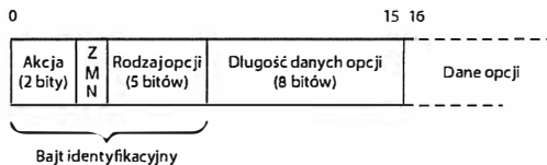
Rysunek 5.7. Schemat TLV kodowania opcji IPv6. Pierwszy bajt, identyfikujący typ opcji, dzieli się na trzy podpole: podpole Akcja określa sposób postępowania w przypadku nierozpoznania opcji przez router lub host, podpole ZMN oznacza zezwolenie (1) albo brak zezwolenia (0) na modyfikowanie opcji przez routery pośredniczące, zaś w polu Rodzaj opcji znajduje się identyfikator określający funkcję spełnianą przez opcję. W drugim bajcie wskazany jest jawnie rozmiar danych związanych z opcją
