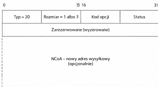
Rysunek 8.57. Opcja Neighbor Advertisement Acknowledgment wykorzystywana przez FMIPv6. Gdy węzeł mobilny przemieszcza się między routerami dostępowymi i proponuje swój nowy adres przekierowania, nowy router przekazuje w ten sposób akceptację dla tego adresu
