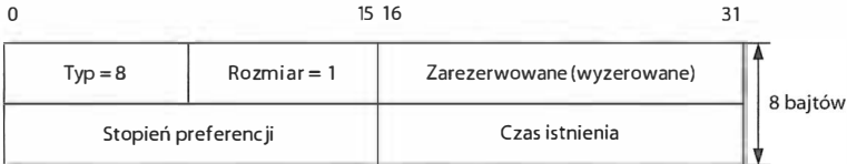
Rysunek 8.47. Opcja Home Agent Information określa stopień preferencji w zakresie używania danego routera jako agenta domowego w mobilnym IPv6 oraz okres czasu, w jakim router ten skłonny jest podjąć się pełnienia tej funkcji
